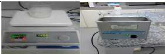
Figura 1.- Equipos agitador magnético y ultrasonido
